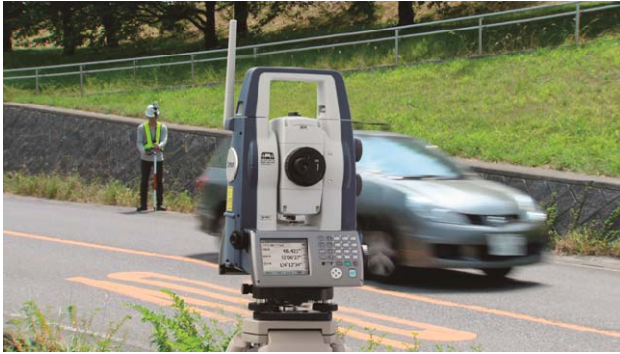
TSによる距離と角度の観測及びプリズム (左: 株式会社トプコンソキアポジショニングジャパン提供)
