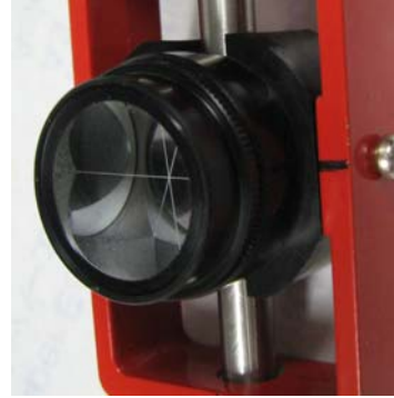
TSによる距離と角度の観測及びプリズム (左: 株式会社トプコンソキアポジショニングジャパン提供)
