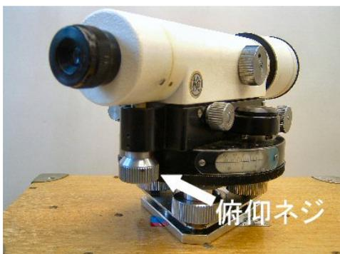
俯仰ネジをまわし、合致式気泡管水準器の両端の映像を合致させる。
