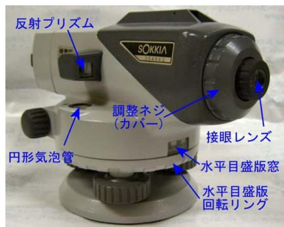
オートレベルは、チルチングレベルで俯仰ネジを用いて手動で合わせていた視準線の傾きを、内蔵されたコンペンサータ（振子とオイルダンパーを組み合わせたもの）により補正可能な範囲（レベルを円形気泡管により据付けた場合）であれば、常に自動で水平な視準線を保つ事ができるレベルである。
