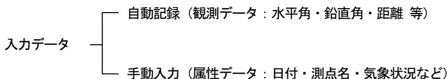
さらに観測前の手動入力では、較差の制限などの許容値も入力する事ができ、その後点検計算まで自動的にDC内で処理される。このため、制限値を越えるデータがある場合には、自動的に再測の表示がされ、観測者は指示に従って再測を行えばよい。なお一般的なDCでは、この時の再測データが記録媒体に保存される。DCに保存された観測データは、測量の品質を保証するために、簡単に修正や消去ができないようになっている。
